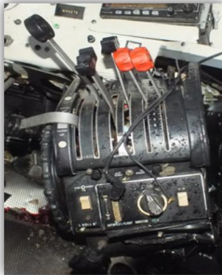
Fotografía No. 6: Pedestal central de la aeronave
