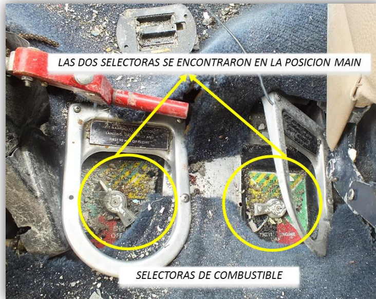
Fotografía No. 12: Selectoras de combustible
